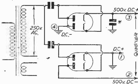
Fig. 3.—A simple quadrupler circuit.
