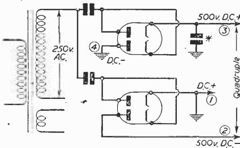
Fig. 3.—A simple quadrupler circuit.
