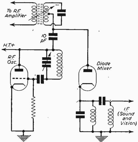
Fig. 3.—Diode Mixer Circuit.
