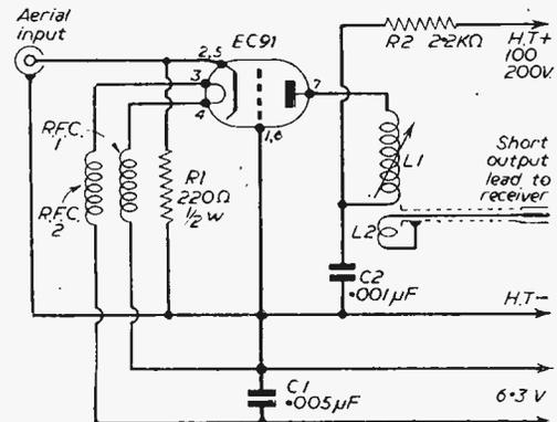
Fig. 2.—Isolating pre-amplifier.
