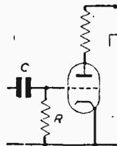
Fig. 5.—A sync separator circuit.
