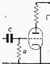
Fig. 5.—A sync separator circuit.
