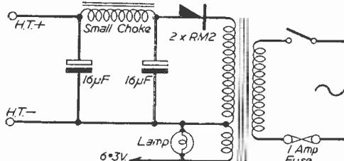
Fig. 3.—Circuit using a metal rectifier.
