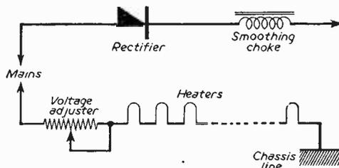
Fig. 2.—The normal D.C. mains input.
