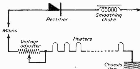
Fig. 2.—The normal D.C. mains input.
