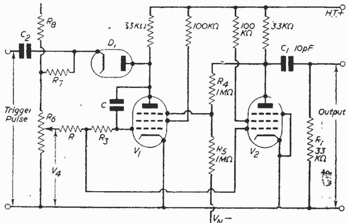
Fig. 2. --The Miller-Sanatron circuit.
