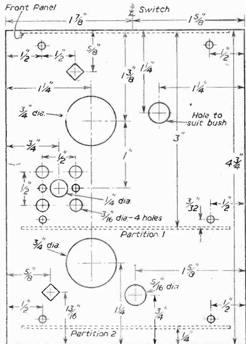
Fig. 4(a).—The top plate drilling data.
