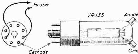
Fig. 2.—Twin cap V.H.F. triode.
