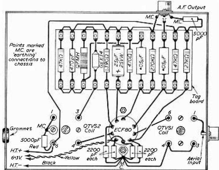
Fig. 3.—The complete wiring plan.
