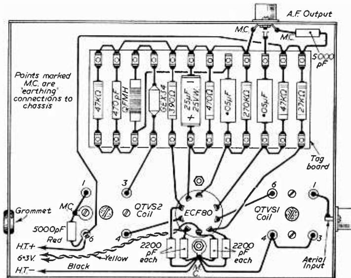
Fig. 3.—The complete wiring plan.
