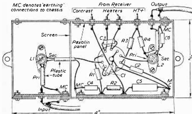
Fig. 2.—The wiring diagram.
