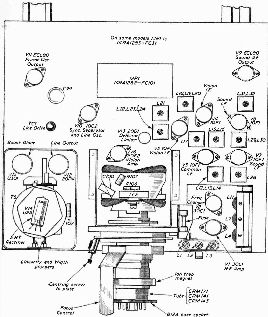
Fig. 2.—The above-chassis layout.
