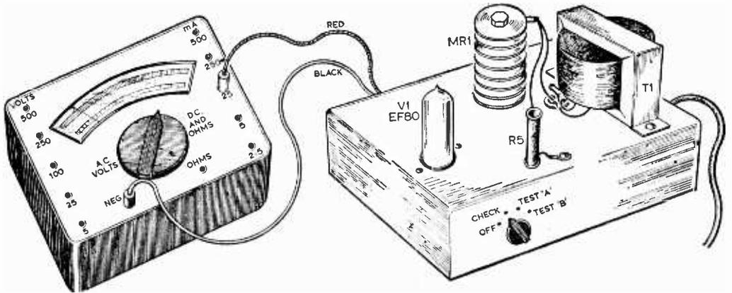
Fig. 3—The above-chassis layout.
