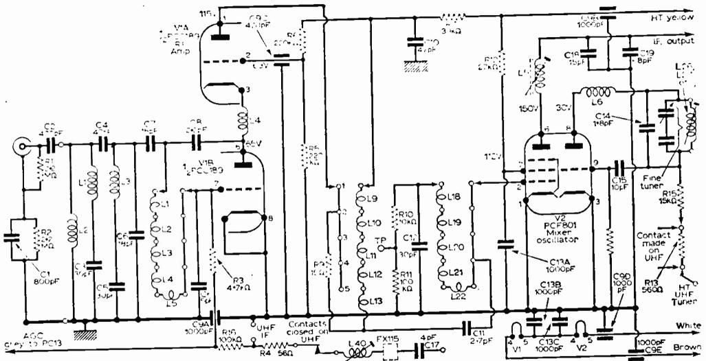
Fig. 1—V.H.F. tuner unit.
