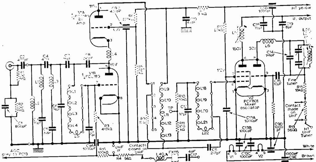
Fig. 1—V.H.F. tuner unit.
