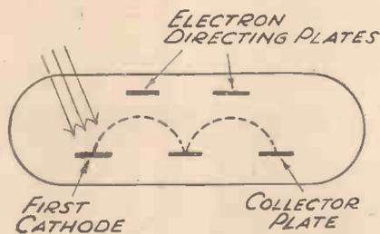
Fig. 2.—One form of Zworykin multiplier.
