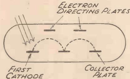
Fig. 2.—One form of Zworykin multiplier.
