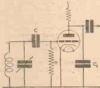
Fig. 26.—The standard grid rectifier circuit.
