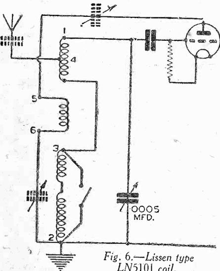
Fig. 6.—Lissen type LN5101 coil.
