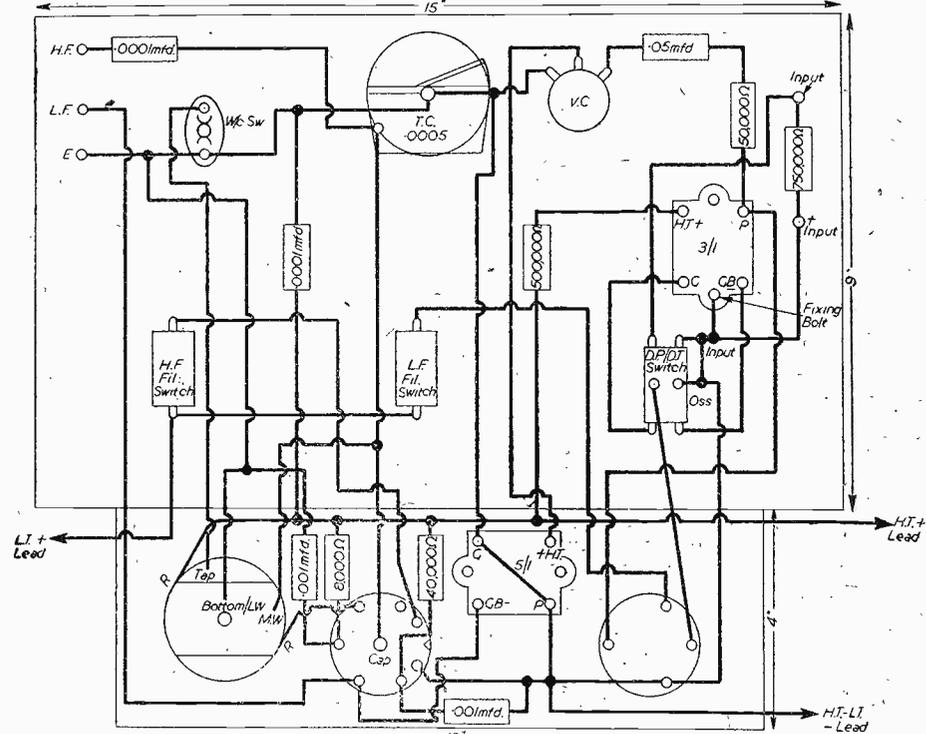
Fig. 3.—Wiring diagram.
