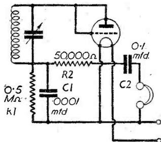
Fig. 1.—A simple diode circuit.
