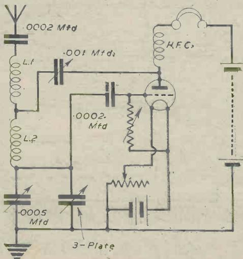
Fig. 3.—The Ultra-Audion circuit.
