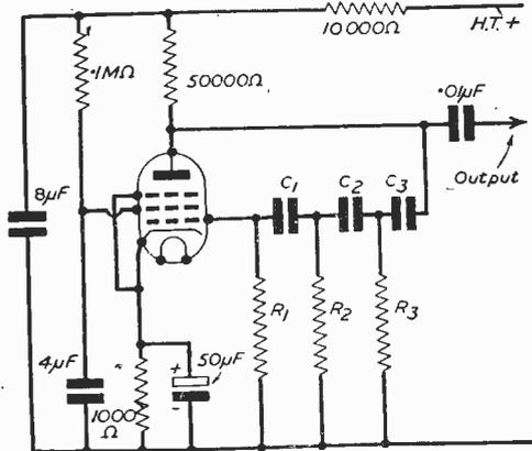
Fig. 5.—An RC oscillator circuit.
