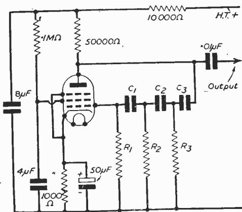
Fig. 5.—An RC oscillator circuit.
