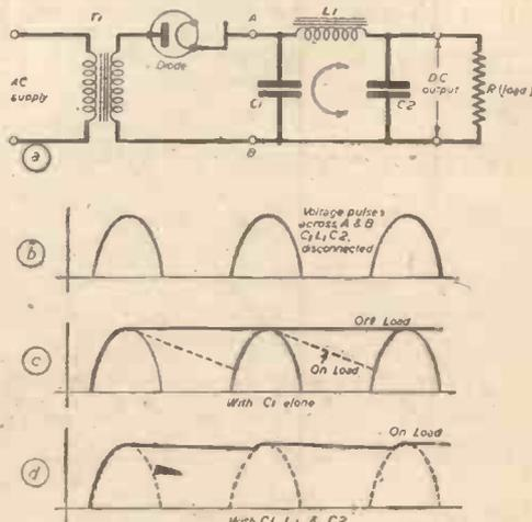
Fig. 15.—The half-wave rectifier.
