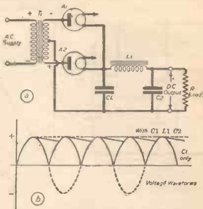
Fig. 16.—The all-wave rectifier.
