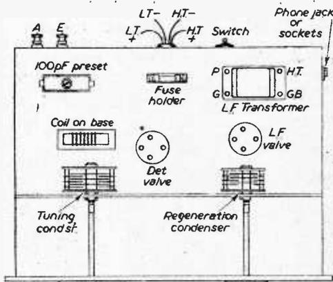
Fig. 3.—Component lay-out.
