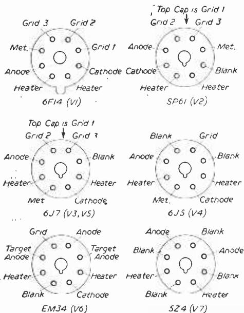
Fig. 5.—Valve base data.
