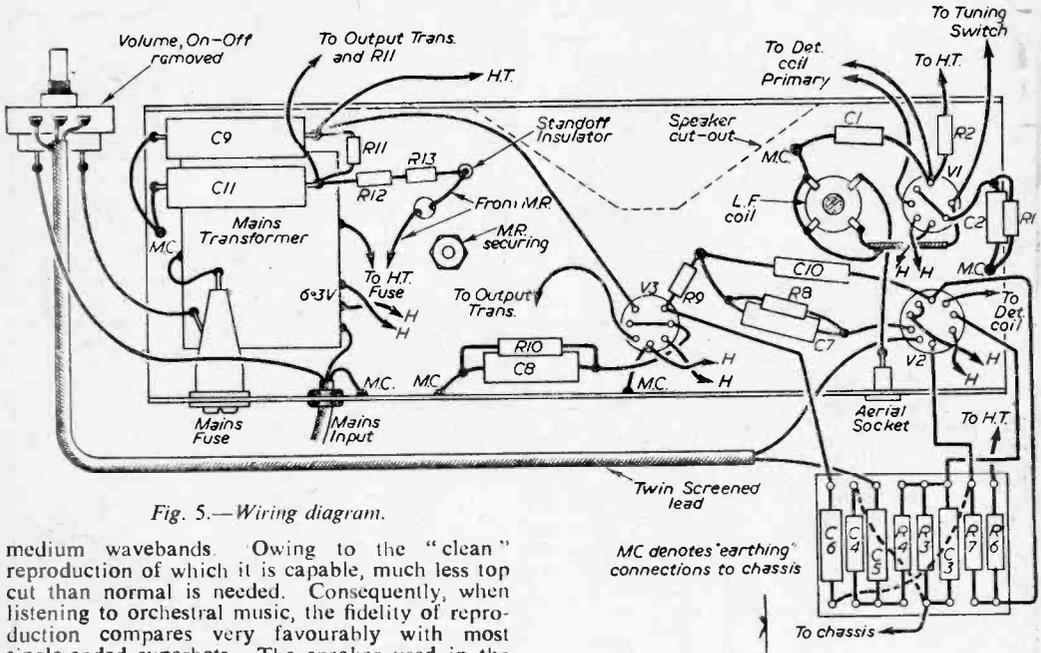
Fig. 5.—Wiring diagram.
