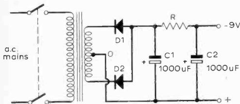
Fig. 8: An a.c. mains power supply. C1, C2—1000µF. D1, D2—BA100, OA202 etc. R—180Ω–390Ω, ½W, to give 9V output.
