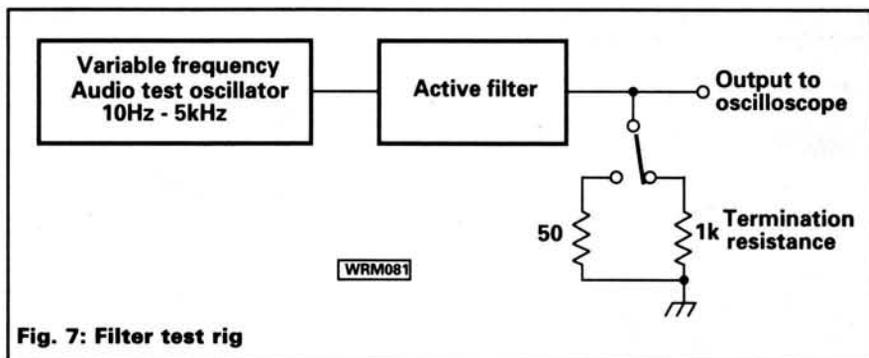
Fig. 7: Filter test rig
