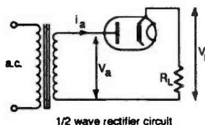
**Fig. 1.6. A half wave rectifier circuit.**
