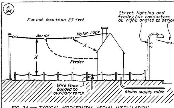
FIG 2A—TYPICAL HORIZONTAL AERIAL INSTALLATION
