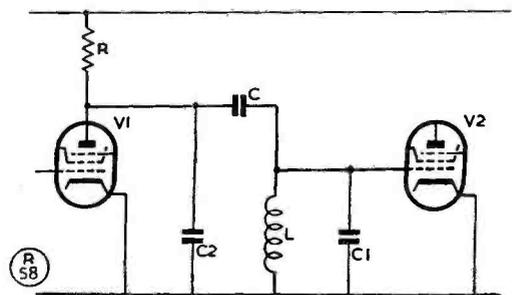
Fig. 1. Coupling circuit.
