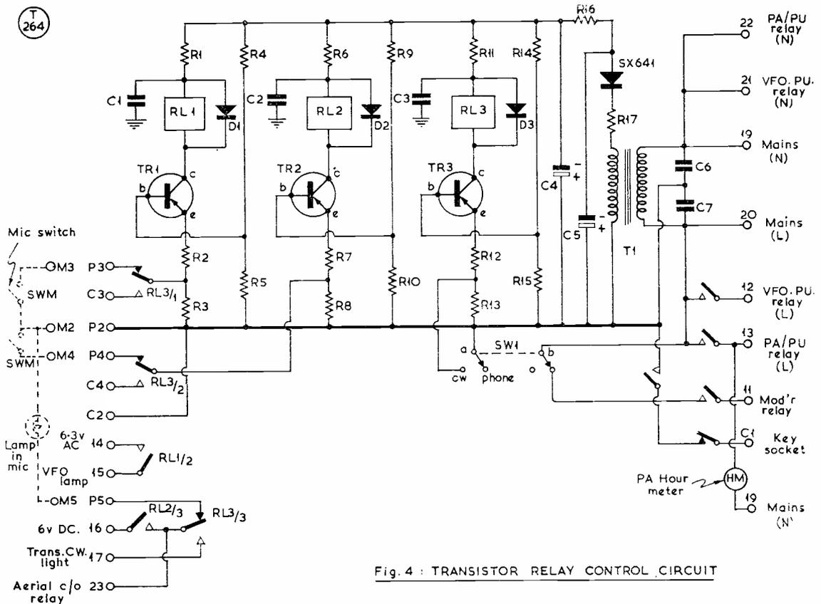
Fig. 4 : TRANSISTOR RELAY CONTROL CIRCUIT
