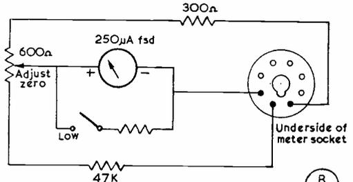
Fig. 2 : S - Meter circuit
