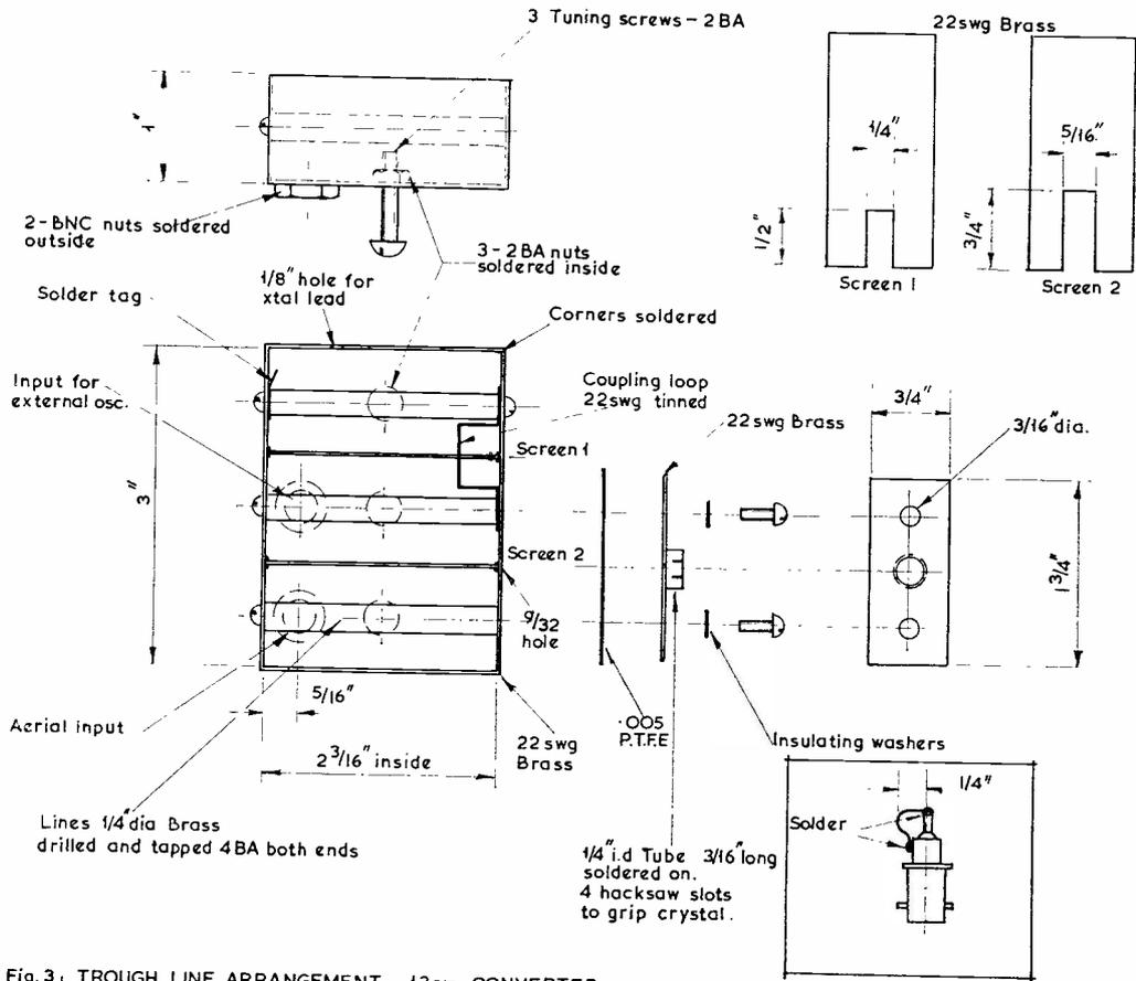
Fig. 3. TROUGH LINE ARRANGEMENT - 13cm CONVERTER
