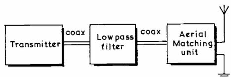
Fig. 1a Block Diagram
