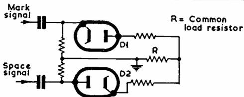
Fig. 3 BASIC DIODE CIRCUIT
