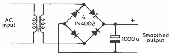
Fig. 1b Full wave Bridge rectifier
