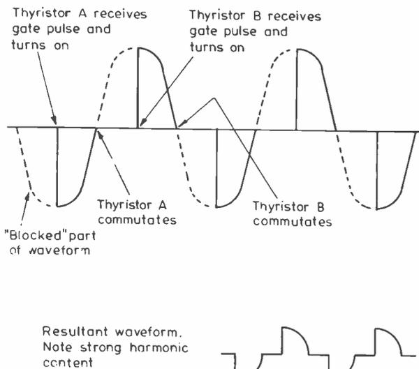
A1 V.WAVEFORMS FOR FULL WAVE THYRISTOR PHASE CONTROL
