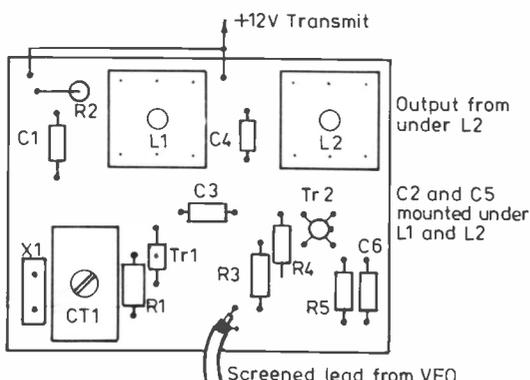
Fig. 4 TRANSMIT MIXER LAYOUT (actual size)
