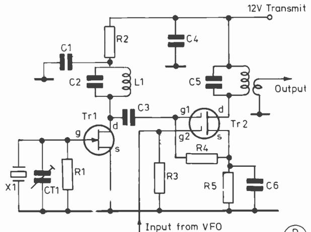
Fig.1 TRANSMIT MIXER CIRCUIT
