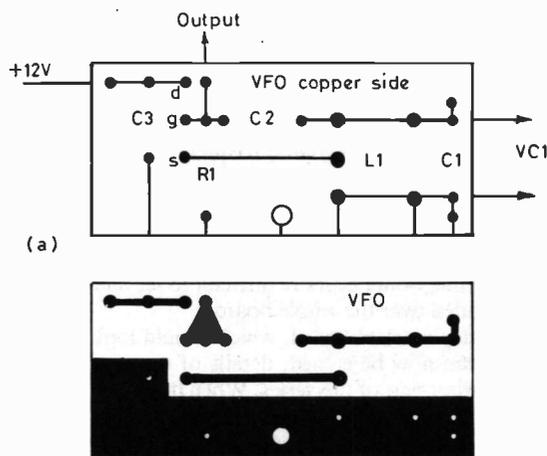
Fig. 3 PCB COPPER SIDE (actual size)
