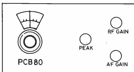
Fig. 7. SUGGESTED FRONT PANEL LAYOUT
