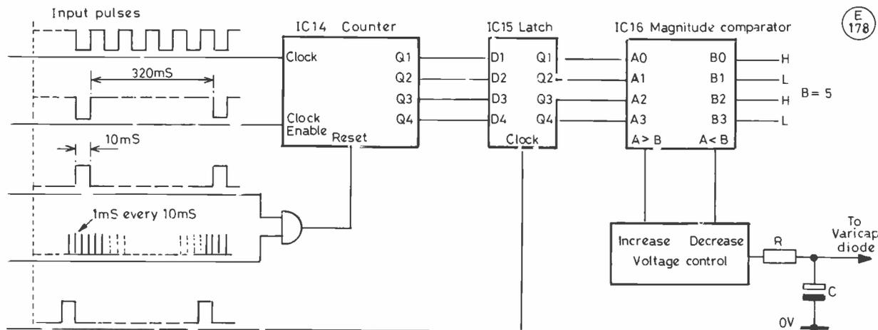
Fig. 1 BLOCK DIAGRAM
