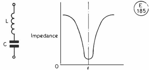
Fig. 1a SERIES RESONANT CIRCUIT
