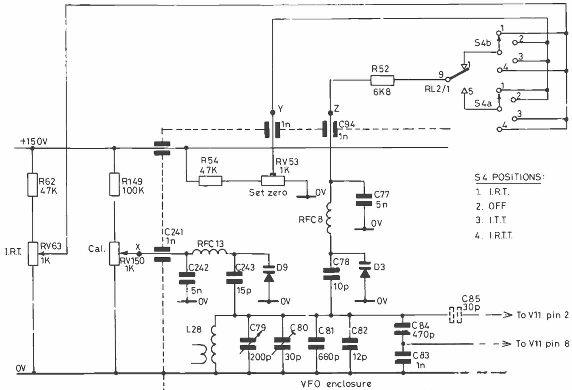
Fig. 3 KW2000B EXISTING I.R.T. CIRCUIT
