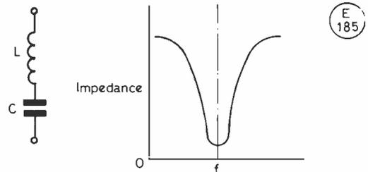
Fig. 1a SERIES RESONANT CIRCUIT
