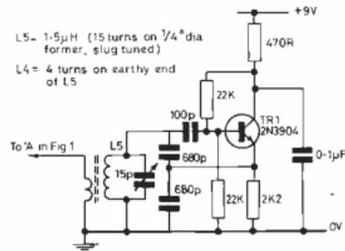
Fig 2 LOCAL OSCILLATOR FOR 6-8MHz
