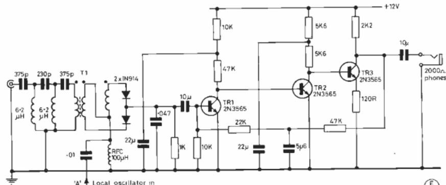
Fig 1 DIRECT CONVERSION RECEIVER FOR 7MHz
