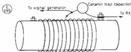
Fig 8 LAYOUT FOR THE INITIAL ROUGH TUNE OF A TRAP
