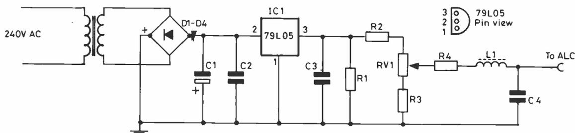
Fig. 1 NEGATIVE VOLTAGE SUPPLY FOR IC-730 POWER CONTROL
