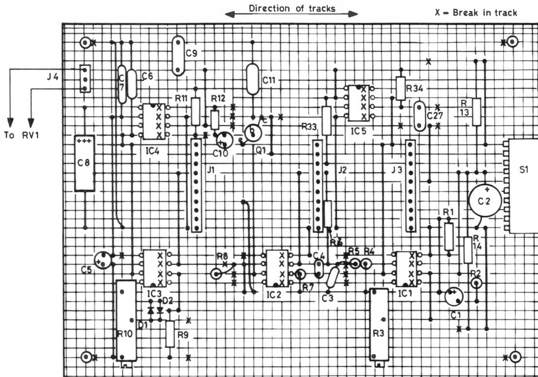
Fig. 4 PLL /TONE DECODER MOTHERBOARD - VEROBBOARD LAYOUT (Full size)
