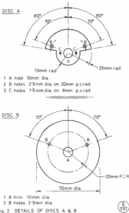
Fig. 2 DETAILS OF DISCS A & B
