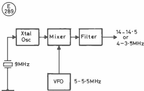
Fig. 3a A MIXER VFO BLOCK DIAGRAM
