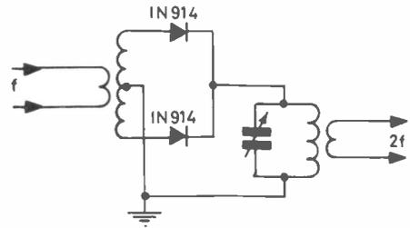
Fig. 2b A DIODE MULTIPLIER
