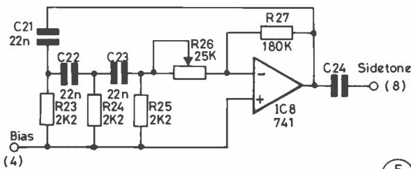
Fig.9a AF SIDE TONE OSCILLATOR CIRCUIT
