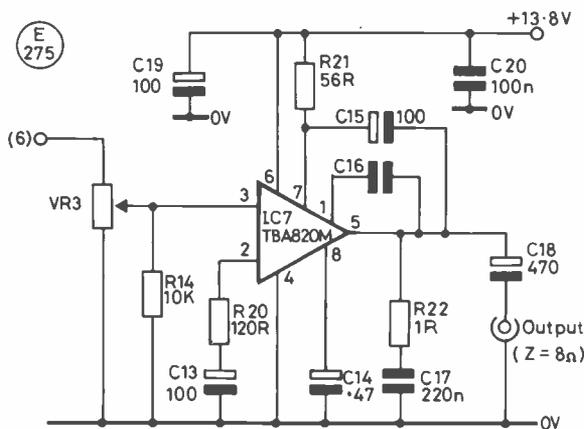
Fig. 8a AUDIO POWER AMPLIFIER CIRCUIT
