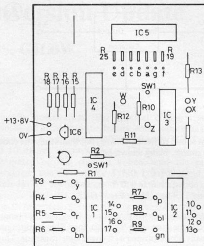
Fig. 5 Component overlay
