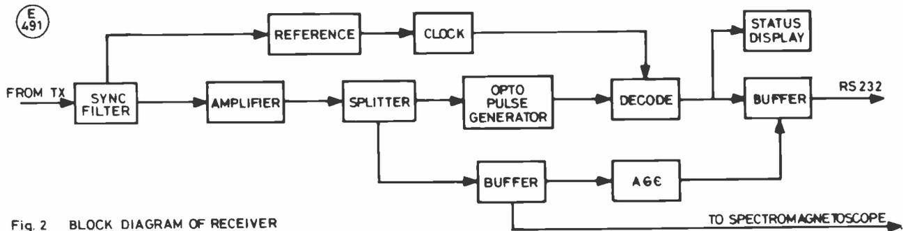
Fig. 2 BLOCK DIAGRAM OF RECEIVER
