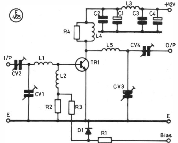
Fig.1 HOWES PA 2/30 VHF LINEAR AMPLIFIER
