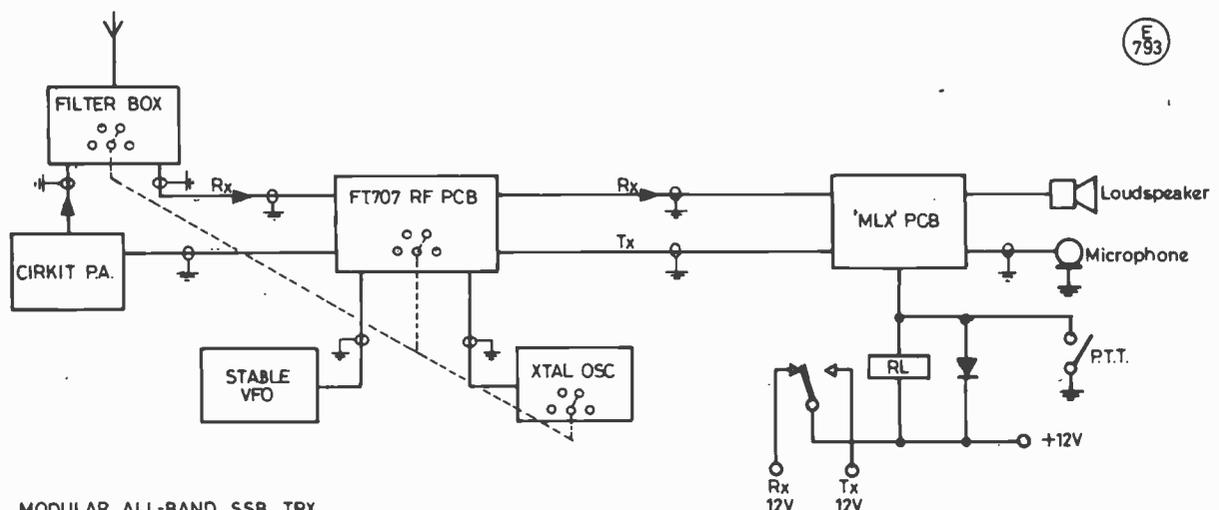
Fig. 1 MODULAR ALL-BAND SSB TRX
