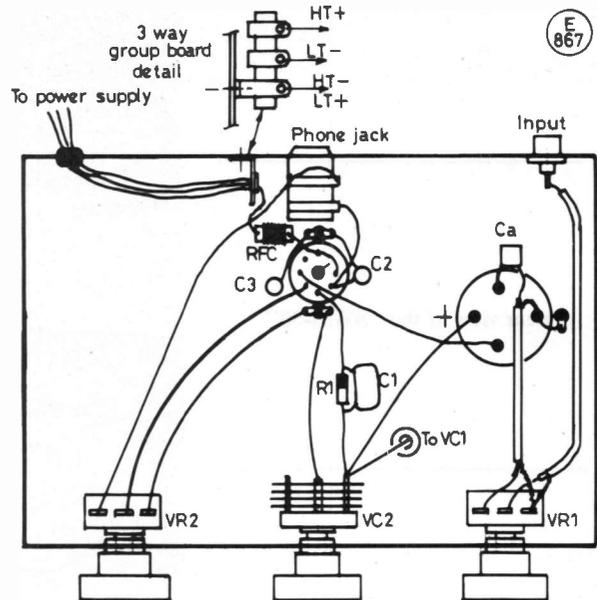
Fig. 2 LAYOUT UNDER CHASSIS
