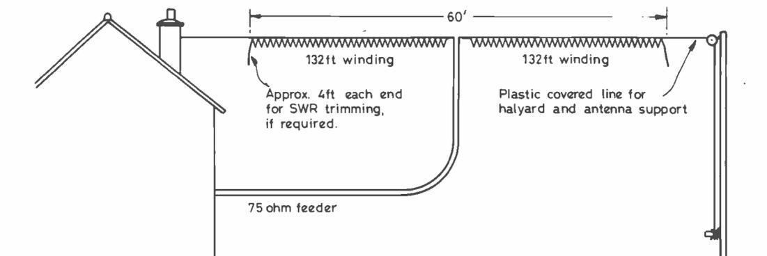
Fig. 1. BASIC LAYOUT OF THE 160m HELICAL HALF WAVE DIPOLE
