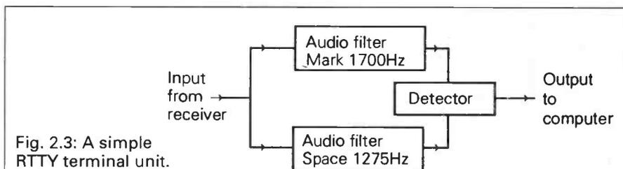
Fig. 2.3: A simple RTTY terminal unit.
