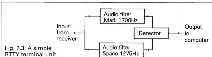
Fig. 2.3: A simple RTTY terminal unit.
