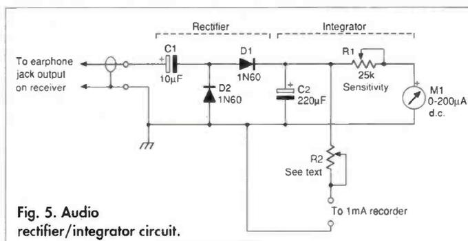
Fig. 5. Audio rectifier/integrator circuit.
