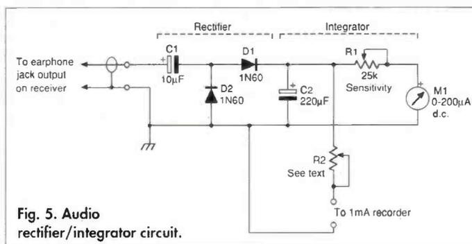
Fig. 5. Audio rectifier/integrator circuit.
