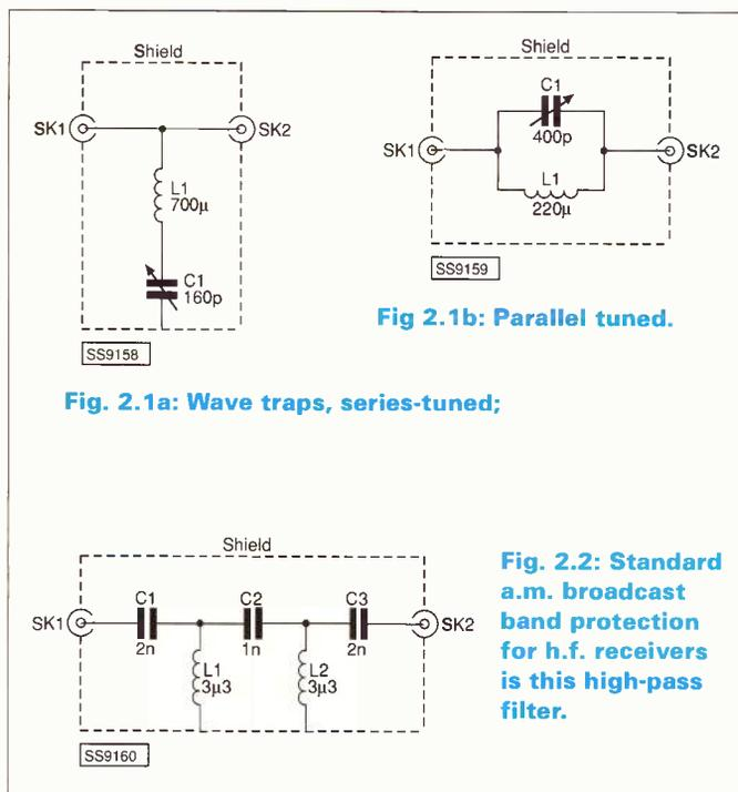
Fig. 2.1a: Wave traps, series-tuned;
