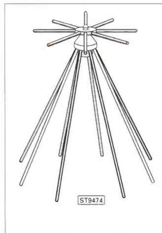
Fig. 5: The discone antenna.
